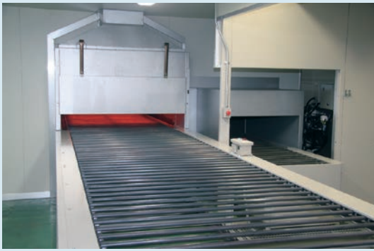
写真右：樹脂製品用指触乾燥炉入り口 写真左：金属製品用ハイブリッド乾燥炉入り口
